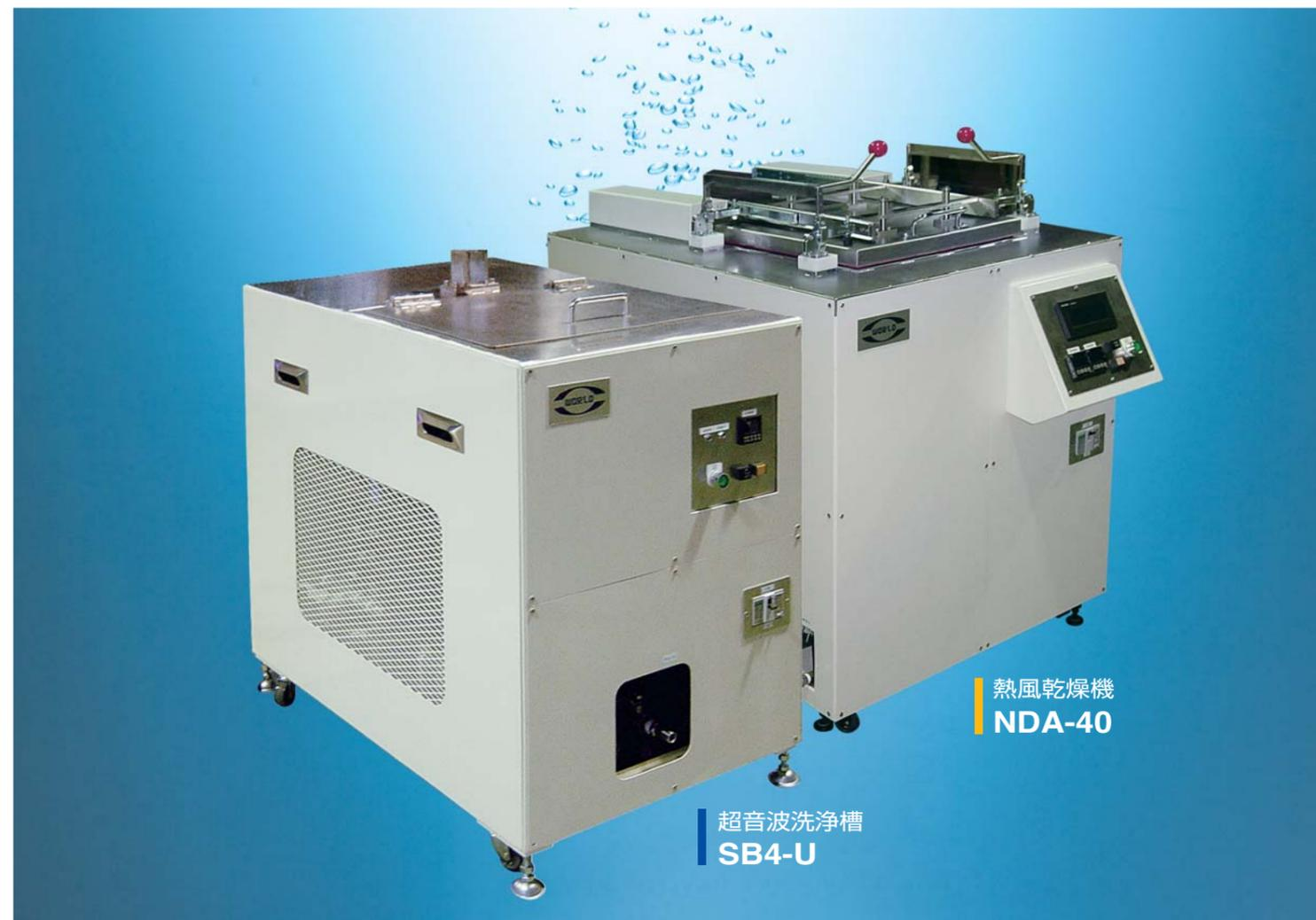
■ 炭化水素系洗浄は、金属加工、樹脂加工、電子部品などの精密洗浄、複雑で微細な箇所の洗浄に効果を発揮し、洗浄の要でもある乾燥機とのユニットで、高精度なシステムを安価に組むことが可能です。
